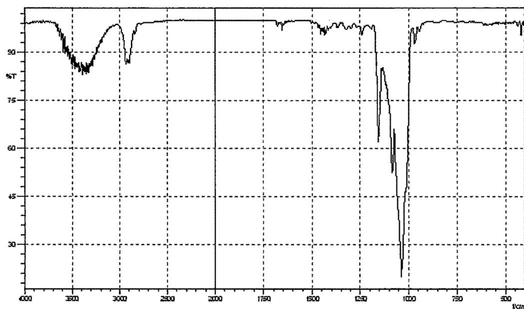
Figure 4.3.2.3.13. IR Spectrum of DM- $\beta$ -CD-Tadalafil inclusion complex(3:1).
